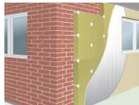
Princip for udvendig isolering
