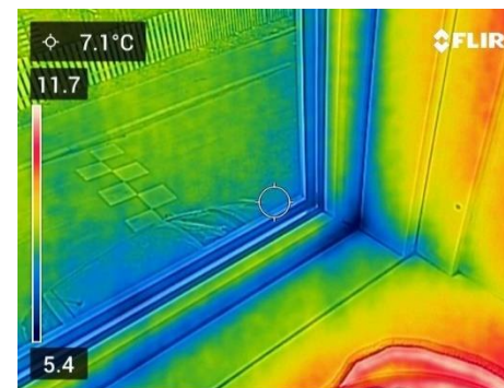
På termofotoet kan man se, hvor kolde kanterne på et ældre termoglas er.
