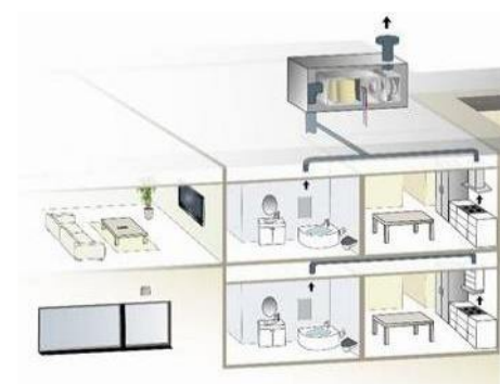
Eksempel på varmegenvinding på eksisterende udsugningsanlæg
